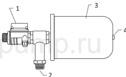
Комплект автоматики состоит из блока управления ТУРБИ-М1 – (1), пластикового тройника 1” с наружной резьбой для соединения с выходным отверстием насоса – (2) и гидроаккумулятора, емкостью 2л – (3). На корпусе гидроаккумулятора расположен ниппель для регулирования давления воздуха – (4).
