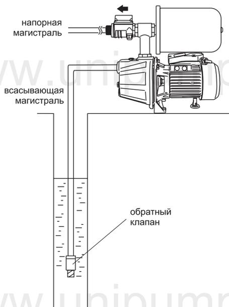
Смонтируйте всасывающую магистраль в соответствии с инструкцией по эксплуатации поверхностного насоса. Присоедините комплект автоматики АКВАРОБОТ ТУРБИ-М1 к выходному отверстию насоса и напорной магистрали.
