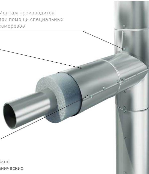
Металлические кожухи Энергопак™ надежно защищают теплоизоляционный слой от механических повреждений, атмосферных воздействий и ультрафиолетового излучения. Оболочки, тройники, отводы, конусные переходы и торцевые заглушки изготавливаются из оцинкованной стали или алюминиевого листа. Высокая прочность, простота монтажа продуманный ассортимент делают этот продукт максимально надежным и удобным в обращении.
