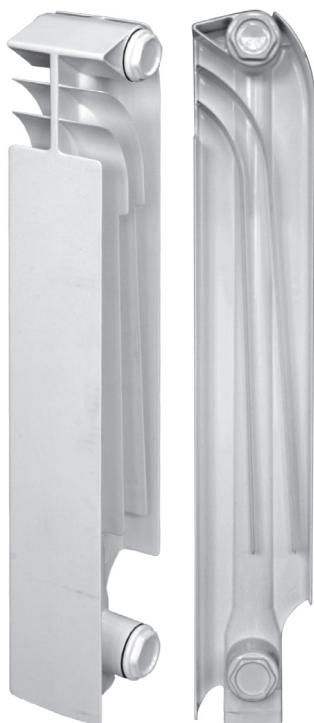
**3.1.** Секции радиатора выполнены из высокопрочного алюминиевого сплава ADC12 по норме JIS H5302 (примерно соответствует российской марке AK12M2 по ГОСТ 1583-93) методом литья под давлением.
