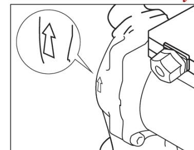
5.1. Направление движения теплоносителя должно совпадать с направлением стрелки на корпусе насоса.
