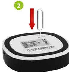
Убедиться, что шлюз подключен к питанию. Затем нажать и удерживать кнопку RESET (с помощью штифта, входящего в комплект) в течение 8 секунд, пока не загорятся оба светодиода индикатора. Это означает, что режим сопряжения активен.
