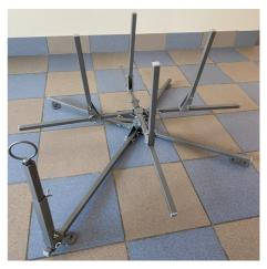
4. На длинную нижнюю опору установить направляющую с кольцом для фиксации трубы, выдвинуть на необходимую высоту и зафиксировать стопорным винтом.
