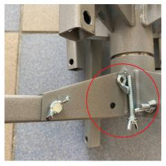
**3.** Разложить опору в рабочее положение, совместить отверстия под шпильку и зафиксировать гайкой. Тем же способом выполнить раскладку других опор.
