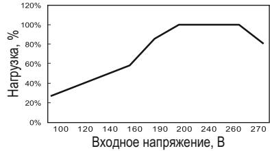
Максимально допустимая нагрузка должна соответствовать показателям, приведенным на диаграмме зависимости мощности стабилизатора от входного напряжения. Убедитесь, что суммарная нагрузка не превышает выходной мощности стабилизатора при возможных входных напряжениях сети.
