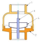
Внутри корпуса, выполненного из двух латунных (CW617N) деталей 1 и 2 свободно перемещается по направляющим шток 3, к которому приварен поплавок 4. Шток и поплавок выполнены из нержавеющей стали AISI 304. В обычном положении поплавок находится в верхней позиции, не препятствуя естественной циркуляции теплоносителя. При включении циркуляционного насоса, расположенного на обводящем участке (байпасе), клапан закрывается, включая в работу обводящий участок.
