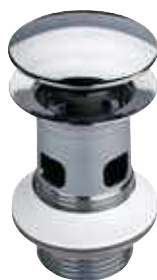
Стержневой выпуск Visign V1 из латуни, хромированный, с функцией перелива, незапирающийся или запирающийся с круглым нажимным клапаном
