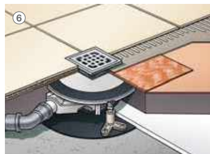
6 Превосходный результат: смонтированный всего в несколько этапов напольный трап Advantix Top с конструктивной высотой 85 мм.
