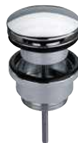
Универсальный выпуск Visign V1 из латуни, хромированный, незапирающийся с круглой накладкой или запирающийся с круглым нажимным клапаном
